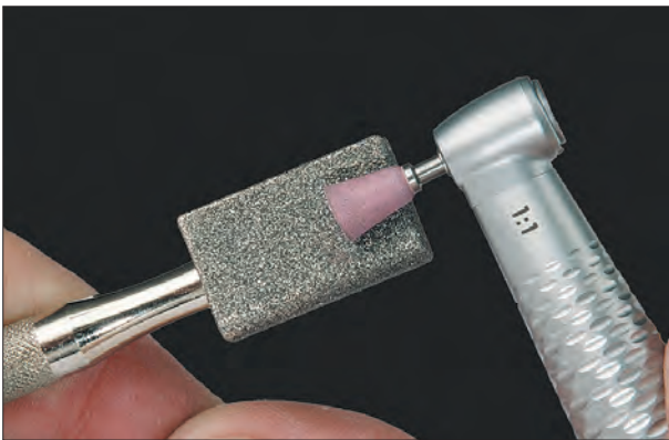
Проверить полиры на повреждения, центричность и чистоту. Очищать поверхность полиров и восстанавливать центричность с помощью правильного камня P4060. Check polishers for damage, concentricity and contamination. Clean the polisher surface and restore concentricity using the dressing instrument P4060.
