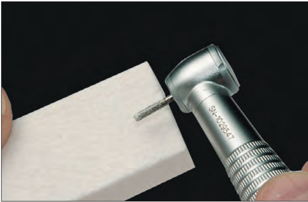
Проверить инструменты на загрязнение и по необходимости почистить. Чистить алмазные инструменты камнем для очистки G9920. Check the instruments for contamination and clean, if required. Clean diamond instruments with the cleaning stone G9920.
